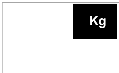
Mauvais placement de la charge
